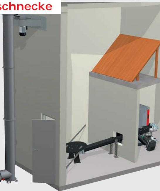
Die Fröling Senkrecht-Förderschnecke setzt neue Maßstäbe bei der Förderleistung (bis zu 45 m<sup>3</sup>/h), Betriebssicherheit und beim Verteilergebnis. Die Hackschnitzel werden vom Aufnahmetrog mit einer Schnecke in die Förderanlage geschoben, die den Brennstoff auf die gewünschte Höhe zur Verteil-Vorrichtung transportiert. Die Senkrecht-förderschnecke ermöglicht so eine staubarme Befüllung des Lagerraums und sorgt für eine gleichmäßige Verteilung des Brennstoffes.
