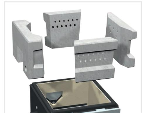
Die patentierte Formgebung der Retortensteine macht die Luftführung in der Brennkammer besonders dicht, ohne dafür aufwändige und verschleißanfällige Dichtungen verwenden zu müssen. Zusätzlich erhöht die neue Form der Retortensteine die Wartungsfreundlichkeit der Brennkammer wesentlich, da diese einfach entnommen werden können.
