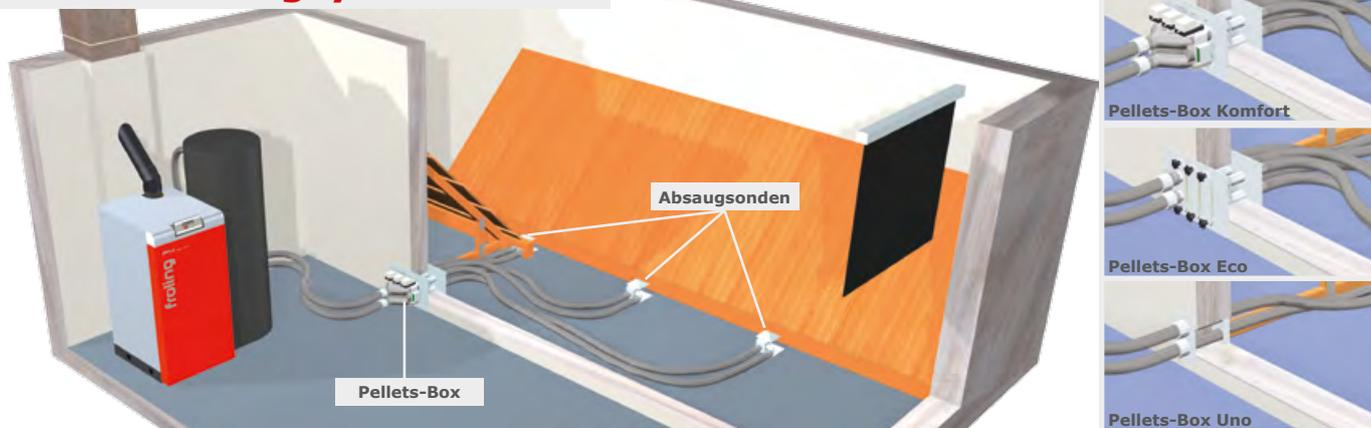
Dieses System besteht durch die einfache Montage und die hohe Flexibilität. Das Universalsaugsystem überwindet auch große Distanzen zwischen Lagerraum und Heizraum. Die Position der Absaugsonden bzw. der Übergabeeinheit (Pellets-Box) kann individuell an die gegebenen Lagerraumsituationen angepasst werden.
