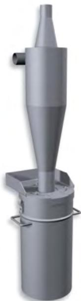
Holzpellets sind sauber und von hoher Qualität. Eventuell vorhandene Restmengen an Holzstaub lassen sich mit dem Pelletsentstauber PST aus dem Brennstoff filtern. Das optimiert die Wirtschaftlichkeit der Verbrennungszone über Jahre hinaus. Der Pelletsentstauber PST wird in die Rückluftleitung des Pellets-Saugsystems an einer frei wählbaren Position eingebaut.
