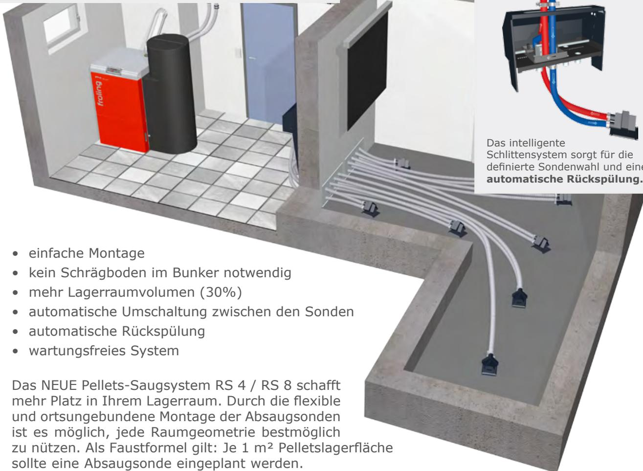
Das intelligente Schlittensystem sorgt für die definierte Sondenwahl und eine **automatische Rückspülung**.
