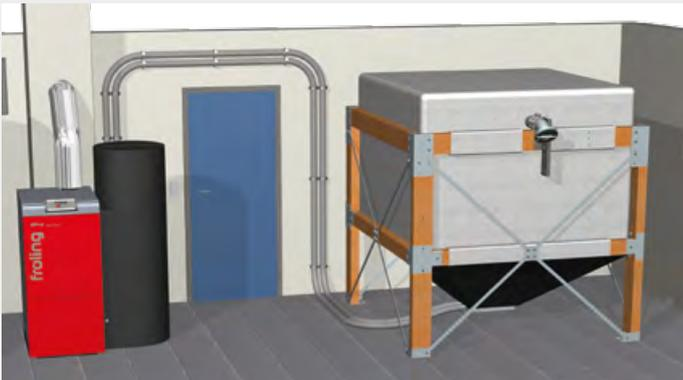
Die Sacksilosysteme bieten eine flexible und vor allem einfache Möglichkeit der Pelletslagerung. Erhältlich in 9 verschiedenen Stellflächen (von 1,5m x 1,25m bis zu 2,9m x 2,9m) mit einem Fassungsvermögen je nach Schüttdichte zwischen 1,6 und 7,4 Tonnen.
