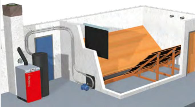
Das Fröling Saugschneckensystem ist die ideale Lösung für rechteckige Räume mit stirnseitiger Entnahme.
